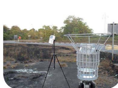
Dispositif mis en place pour la mesure des particules avec un granulomètre
