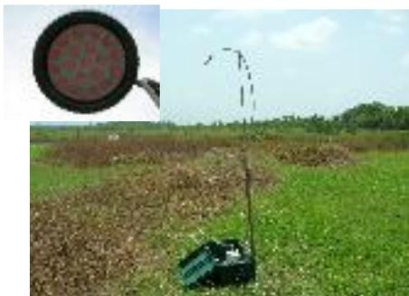
Récolte de poussières sur filtre pour analyse au microscopie électronique en composantes principales et en éléments sélectionnés
